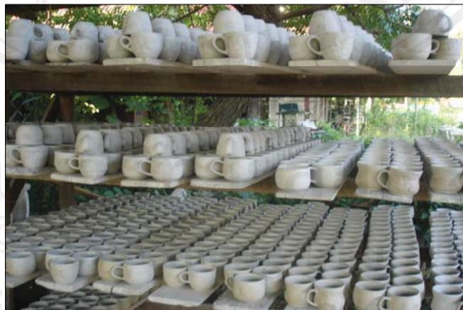
ภาพที่ 8 ถ้วยกาแฟที่ออกจากแม่พิมพ์แล้ว และนำมาตากในที่ร่มให้แห้ง
