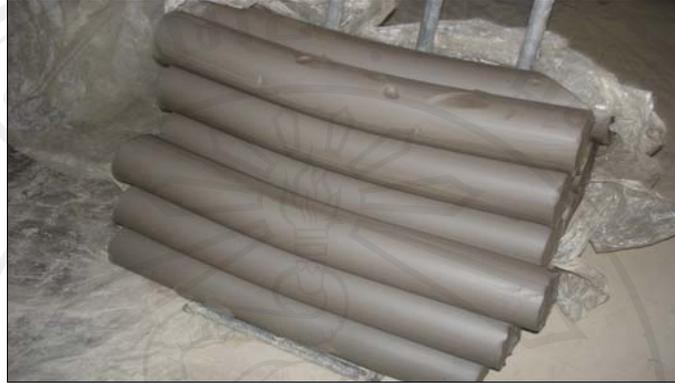
ภาพที่ 2 ดินที่บดละเอียดแล้วจากเครื่องอัดดินจะออกมาเป็นแท่ง ๆ
