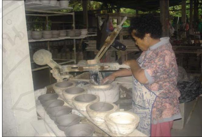
ภาพที่ 5 การขึ้นรูปด้วยเครื่องปั้นจิกเกอร์ด้วยมือ
