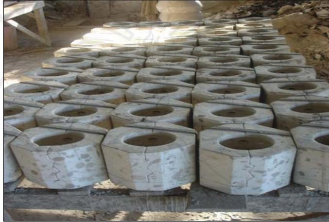
ภาพที่ 7 การขึ้นรูปของถ้วยกาแฟ ใช้วิธีเทแบบลงในแม่พิมพ์
