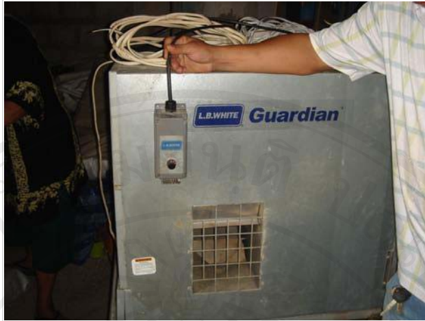
ภาพ 2.1 เครื่องกกไก่อเล็กแบบใช้แก๊ส ประกอบด้วยแผงรับความร้อนสำหรับให้ความร้อนในการกก
