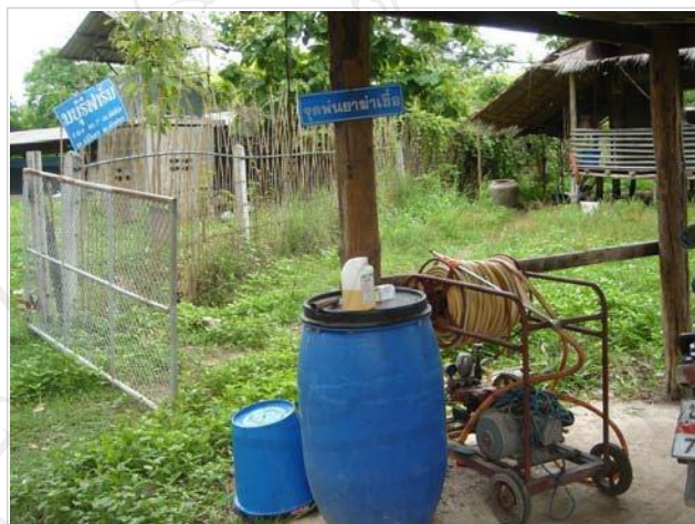
ภาพ 2.8 เครื่องพ่นยาพร้อมถังบรรจุน้ำยามาเชื้อ ตั้งอยู่บริเวณหน้าทางเข้า
