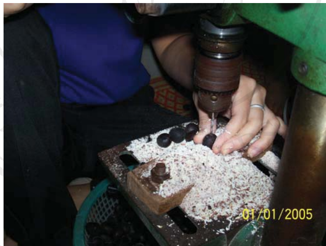
ภาพที่ 3 การนำเมล็ดมะค่าที่เจียรแล้วมาเจาะรู
