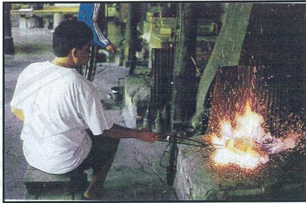
ภาพที่ 3- 44 เผลาไฟอีกครั้งเพื่อให้เศษเงินที่เกิดจากการแกะ อ่อนตัวกลมกลืนกับภาชนะทั้งใบ
