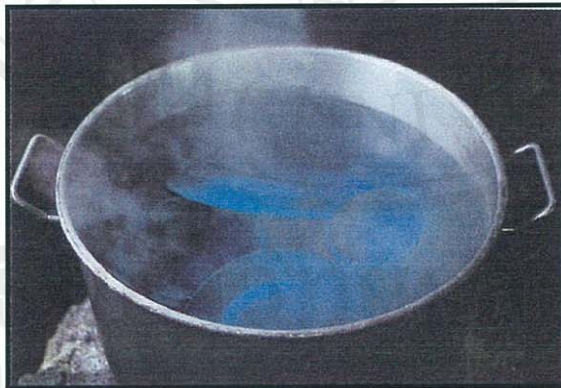
ภาพที่ 3-36 นำเครื่องเงินที่แกะสลักลายแล้วนำไปต้มด้วยน้ำกรดผสมกำมะถัน
