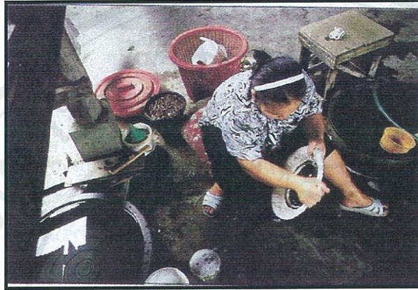
ภาพที่ 3- 37 นำเครื่องเงินที่ต้มแล้วมาขัดให้สะอาด
