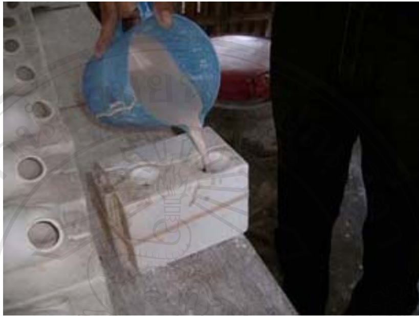
ภาพที่ 11 การเทดินลงในแบบพิมพ์
