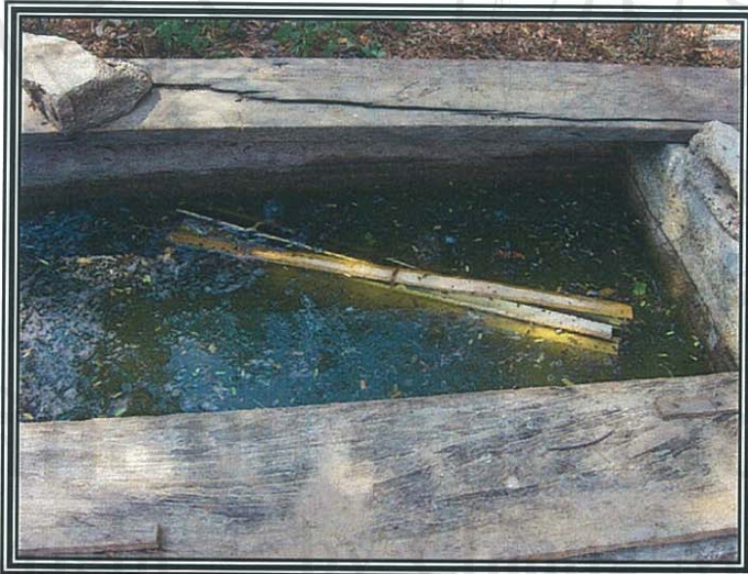
รูปที่ 3-5 การนำไม้ไผ่มาแช่น้ำเพื่อป้องกันมอดและไม้ไผ่แห้ง
