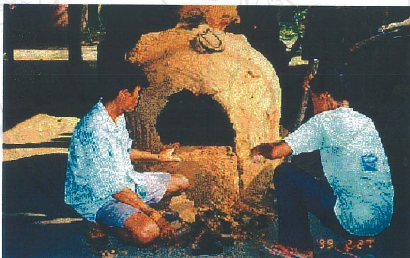
รูปที่ 3.5 การนำถ่านออกจากเตาเผาแบบดินกลบ
