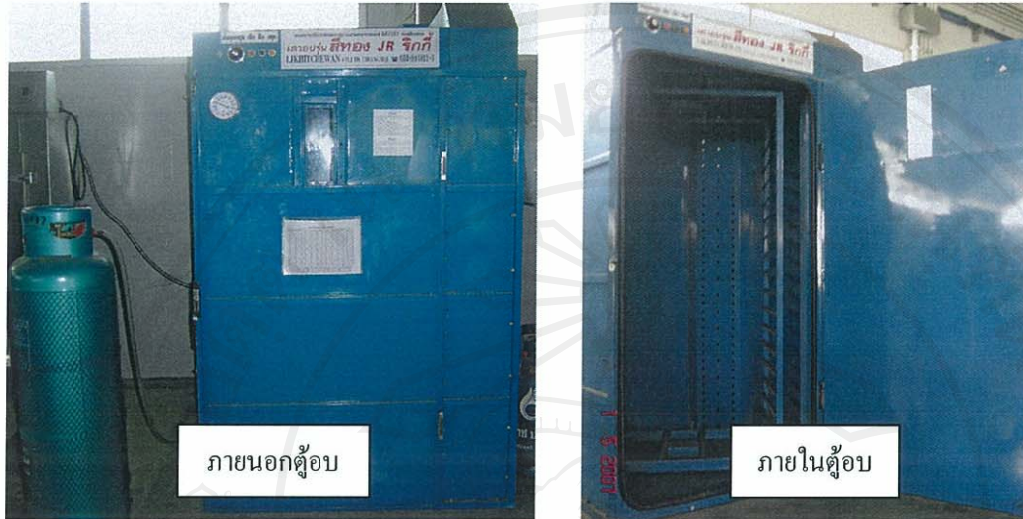
ภาพ ก.3 ตู้อบลมร้อนแบบใช้แก๊สหุงต้มที่ใช้ในการวิจัย
