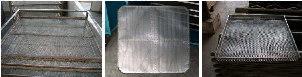
รูปที่ 4.10 ถาดสแตนเลสของเตาแบบอุโมงค์ (ซ้าย) เตาอบลมร้อนแบบหมุน (กลาง) และเตาอบไอน้ำ (ขวา)
