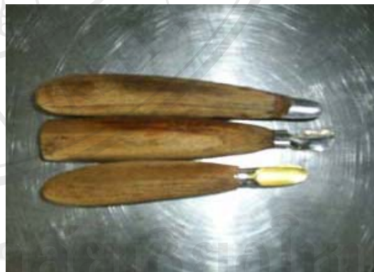
รูปที่ 4.8 ตี๊ดตู่ (ซ้าย) และปลายช้อน(ขวา) สำหรับคว้านเมล็ดลำไย
