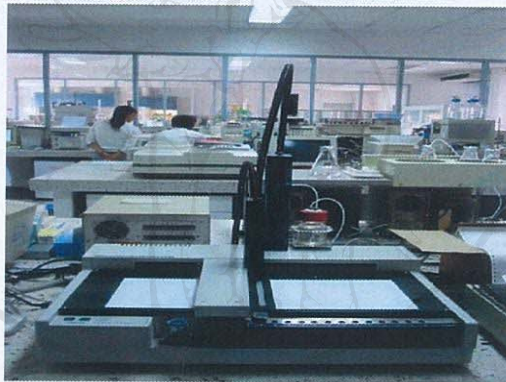
รูปที่ ผ-ค.8 การหยดตัวอย่างลงบนแผ่น TLC ด้วยเครื่อง Camag Automatic TLC Sample III
