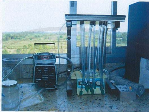
รูปที่ ผ-ค.7 เครื่องระเหยสุญญากาศ : Romer Evap™
