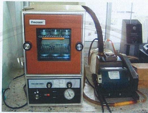
รูปที่ ผ-ง.1 การอบหาความชื้นของถั่วลิสงป่นโดยใช้ตู้อบสุญญากาศ
