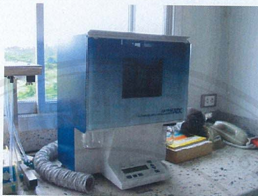
รูปที่ ผ-ค.10 การ run แผ่น TLC ที่หยุดสารแล้วด้วยเครื่อง run แผ่น TLC อัตโนมัติ (Camag รุ่น ADC)
