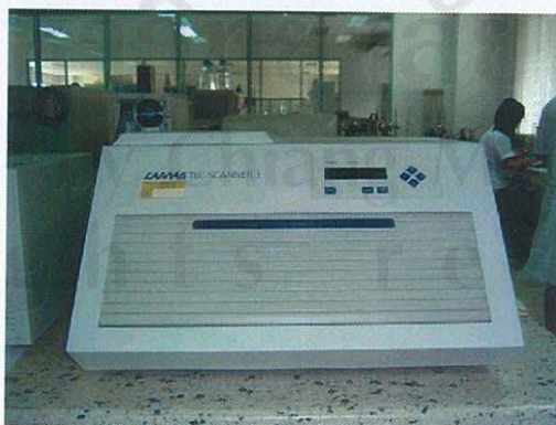
รูปที่ ผ-ค.12 การนำแผ่น TLC มาเข้าเครื่อง Densitometer
