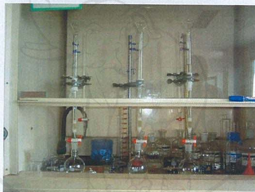
รูปที่ ผ-ค.5 อุปกรณ์การเก็บคลอโรฟอร์มที่ระเหยออกจากรวมจากคอลัมน์
