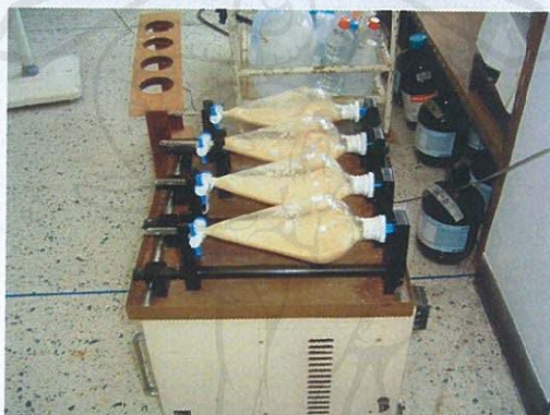
รูปที่ ผ-ค.2 การสกัดอะฟลาทอกซินออกจากถั่วลิสงป่น
