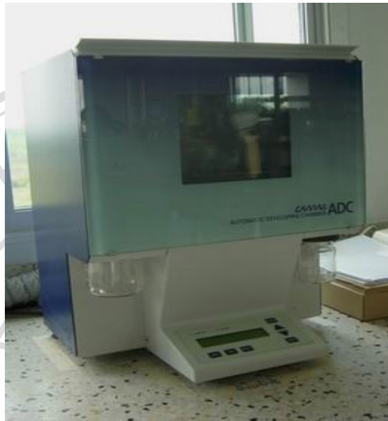
รูปที่ ก-7 เครื่องควบคุมการไหลของน้ำยาบนแผ่น TLC อัตโนมัติ (Automatic Development Chamber ADC 20x20, Switzerland)
