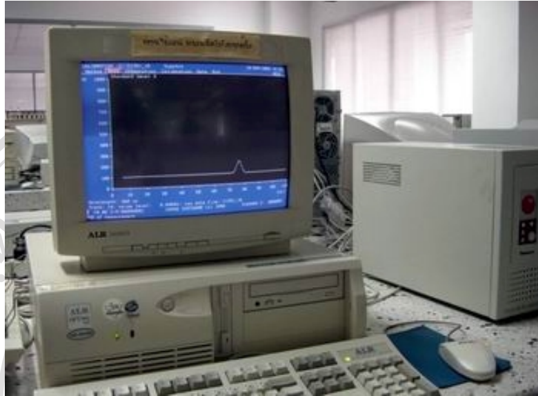
รูปที่ ก-9 เครื่องไมโครคอมพิวเตอร์ที่ควบคุมการทำงานของเครื่อง Scanner 3 (CAMAG, Switzerland)
