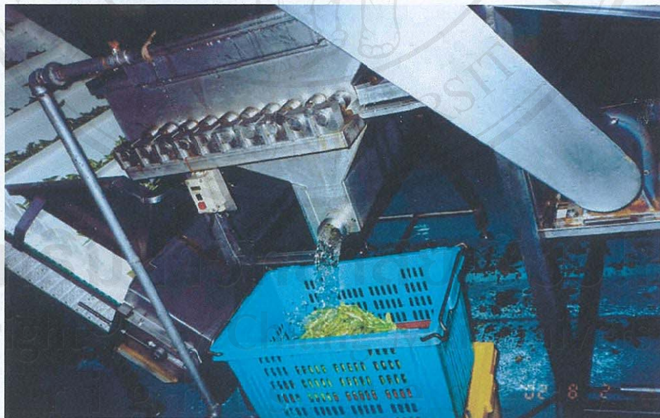
ภาพ ก-4 บริเวณที่เกิดการสูญเสียน้ำบริเวณถังล้าง 3
