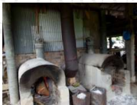
ภาพที่ 25 เตาอบลำไยที่มีการตัดแปลงเพื่อเพิ่มประสิทธิภาพการอบ
