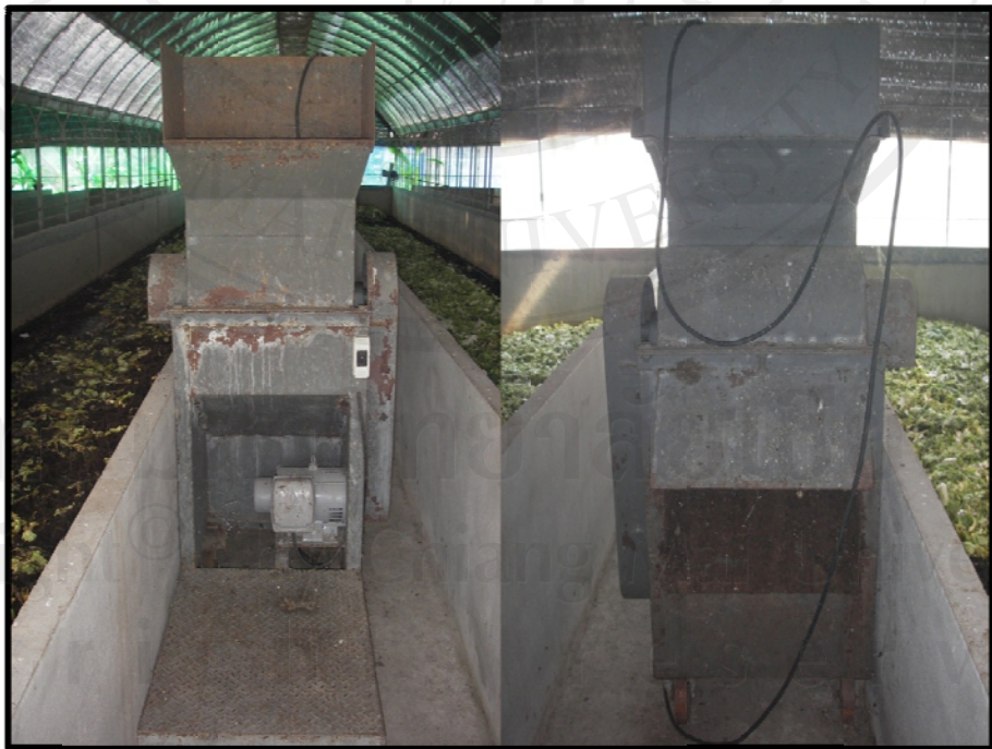
ที่มาจากการสำรวจ รูปภาคผนวกที่ ค.2เครื่องสับย่อยซากพืช
