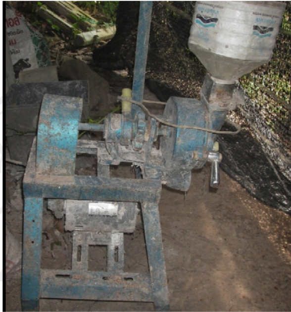
ที่มาจากการสำรวจ รูปภาพหมวดที่ ค.3 เครื่องบดเปลือกไข่
