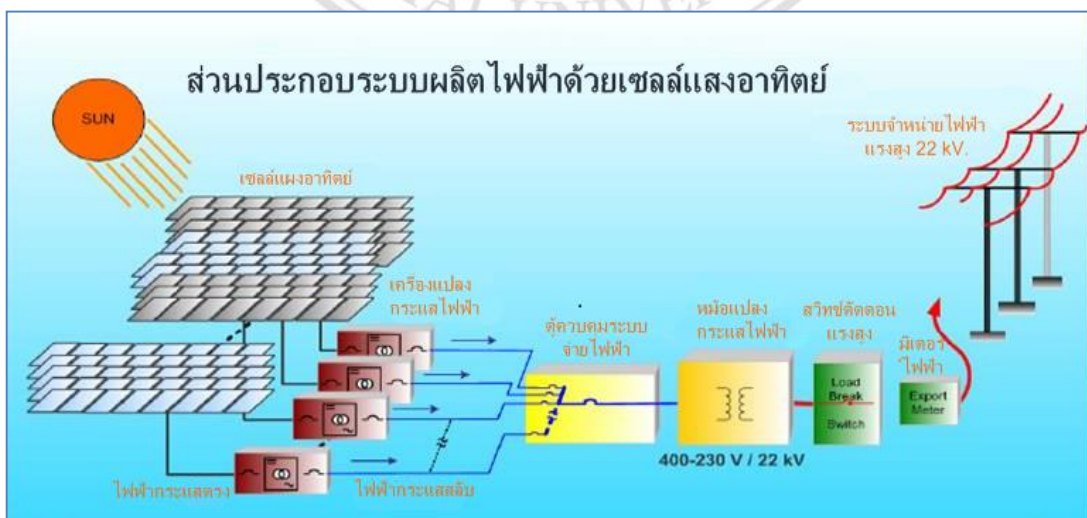
ภาพที่ 23 ส่วนประกอบของระบบผลิตไฟฟ้าด้วยเซลล์แสงอาทิตย์
