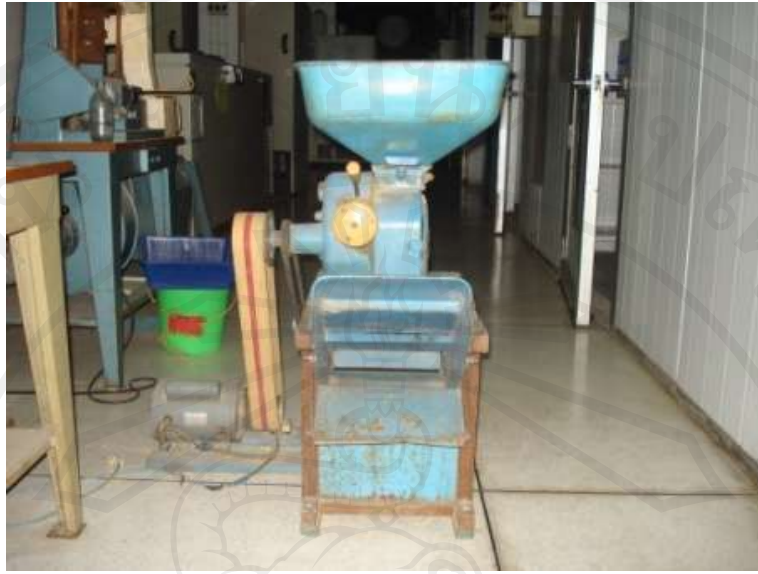
ภาพ 7 เครื่องกะเทาะเมล็ดข้าว (Huller, KM, Japan)
