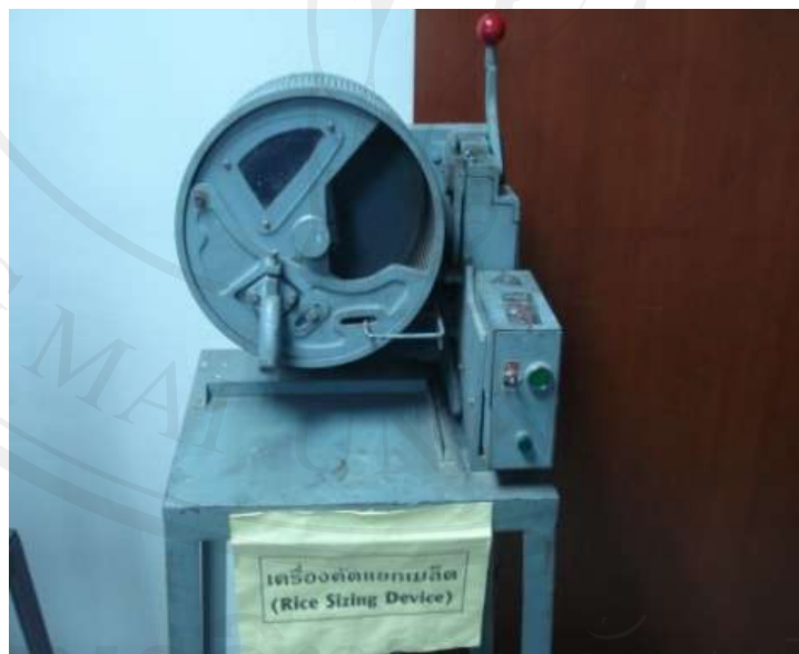
ภาพ 10 เครื่องคัดข้าว (Cylinder separator, DAMAS)
