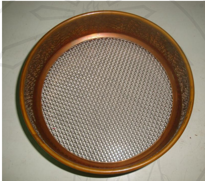
ภาพ 1 ตะแกรง Laboratory test sieve ที่มีช่องเปิดขนาด 2.80 มิลลิเมตร
