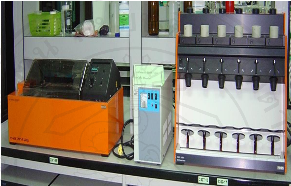
ภาพ 9 เครื่องวิเคราะห์เส้นใยอาหาร (Fiber analyser; Fiber System E)
