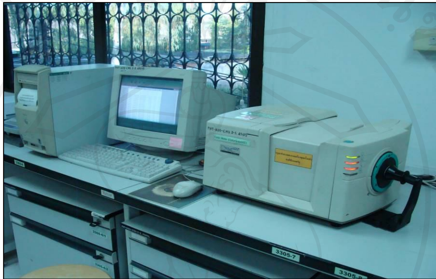
ภาพ ก เครื่องวัดสี (Color meter “Hunterlab” รุ่น Color Quest XE)
