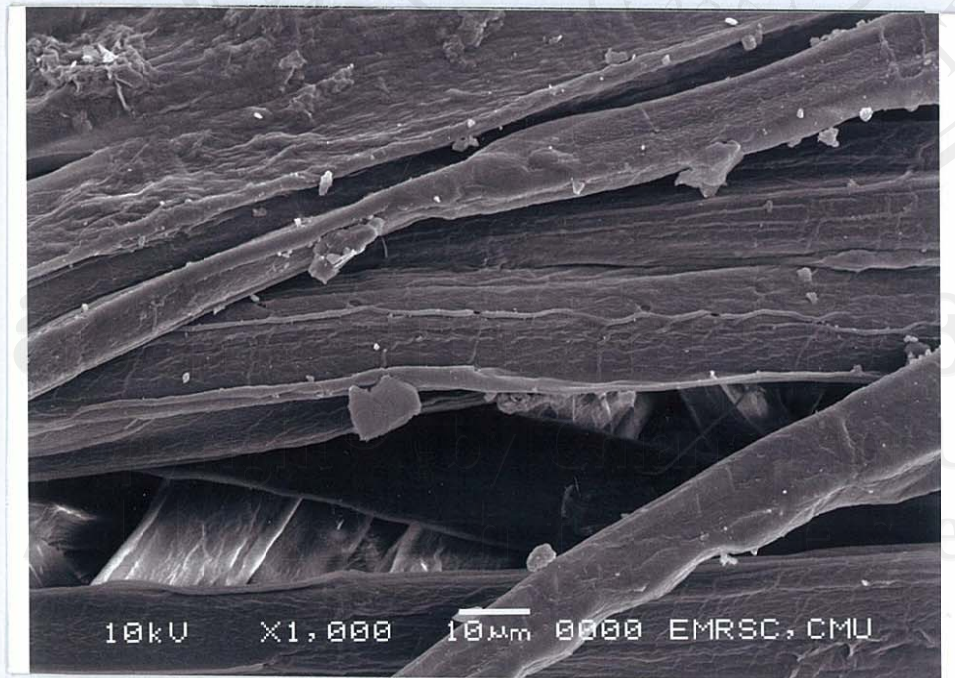
ภาพที่ 4.15 ภาพลักษณะเส้นใยของกระดาษสาแบบบางจากกึ่งเครื่องจักรชนิดอิเล็กทรอนิกส์แบบส่องกราด ที่กำลังขยาย 1,000 เท่า
