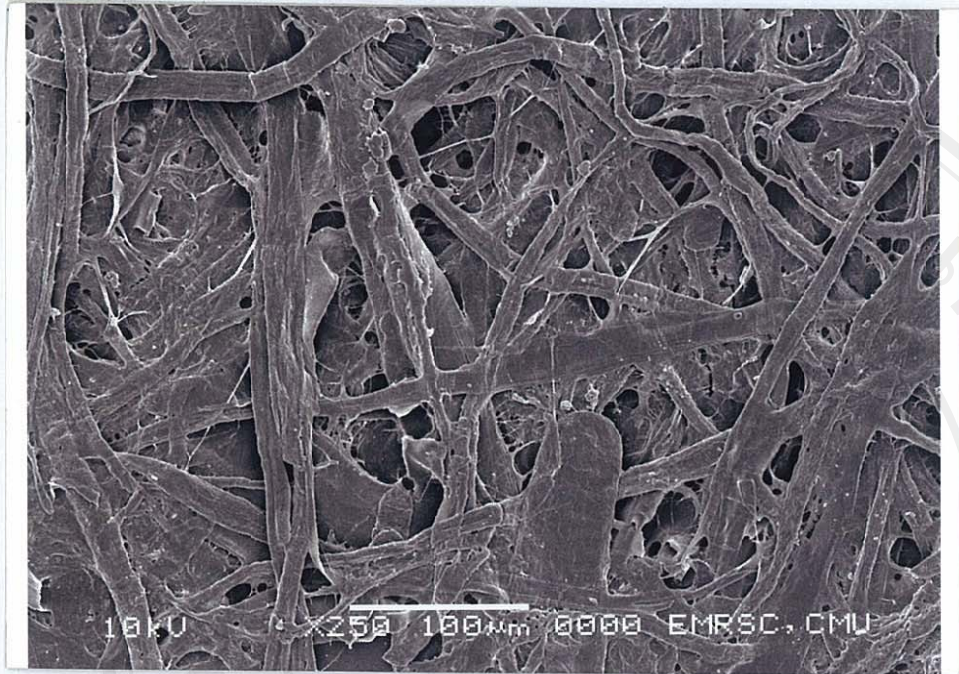
ภาพที่ 4.16 ภาพลักษณะเส้นใยของกระดาษพรุฟจากถัองจุดทรศน์อี่เล็กรอนแบบส่องกราด ที่กำล้งขย 250 เท่า
