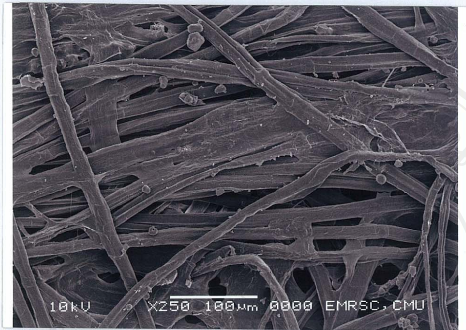
ภาพที่ 4.14 ภาพลักษณะเส้นใยของกระดาษสาแบบบางจากกึ่งเครื่องจักรชนิดอิเล็กทรอนิกส์แบบส่องกราด ที่กำลังขยาย 250 เท่า
