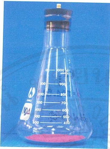
ภาพที่ 3.1 ภาชนะบรรจุสำหรับทดสอบอัตราการดูดกลืนก๊าซเอทิลีน
