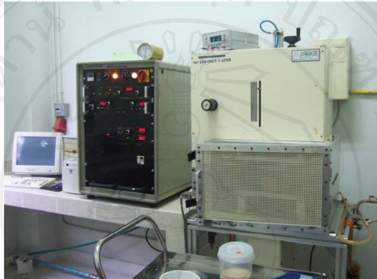
ภาพ 3.4 เครื่องกำเนิดคลื่นความถี่วิทยุ สร้าง และปรับปรุงโดย Institute of Agriculture Engineering, University of Göttingen, Germany ที่ความถี่ของคลื่นวิทยุ 27.12 MHz
