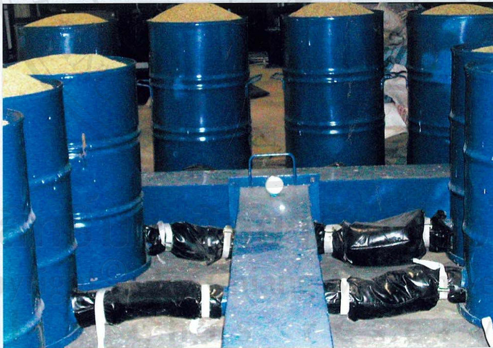
รูปที่ 6 วิธีการลดความชื้นแบบใช้ลมร้อน 40 °C
