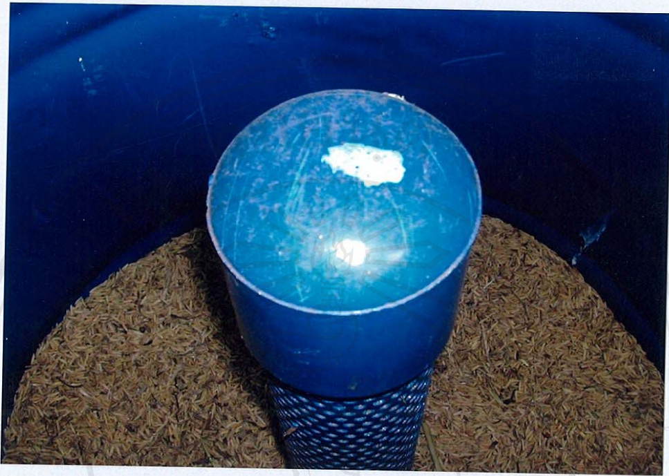
รูปที่ 7 แกนส่งความร้อนภายในถังบรรจุผลผลิต
