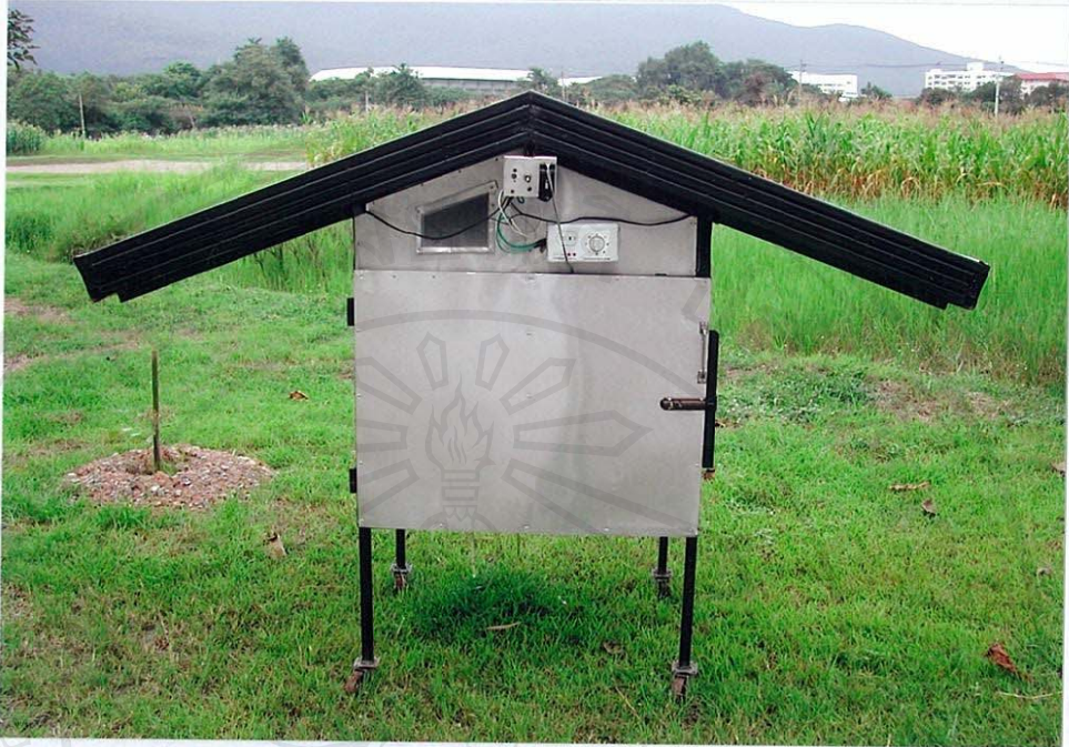
รูปที่ 3.1 เครื่องอบแห้งพลังงานแสงอาทิตย์ที่พัฒนาขึ้นโดย ภาควิชาวิศวกรรมอาหาร คณะอุตสาหกรรมเกษตร มหาวิทยาลัยเชียงใหม่
