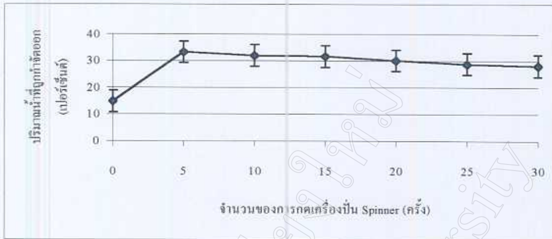
รูปที่ 47 จำนวนครั้งที่เหมาะสมในการรดของเครื่องปั่น Spinner สำหรับทำให้ผักกาดหอมห่อ หันขึ้นสะอาดนี้
