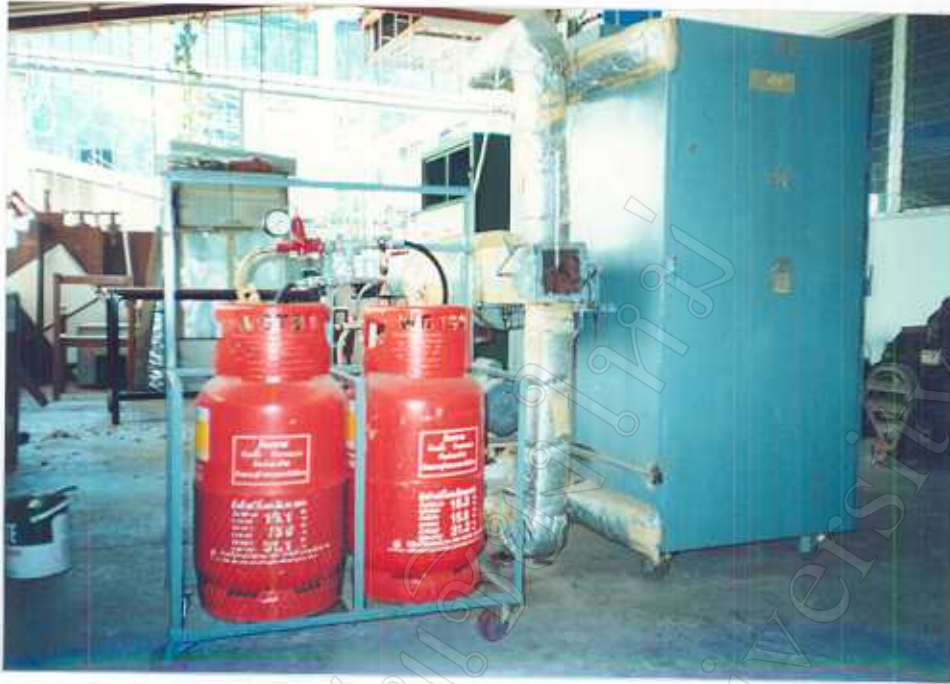
รูปที่ 3.3 เครื่องอบแห้งแบบสลับทิศทางลมร้อนด้านข้าง แสดงท่อลมขาออกด้านบนและด้านล่าง
