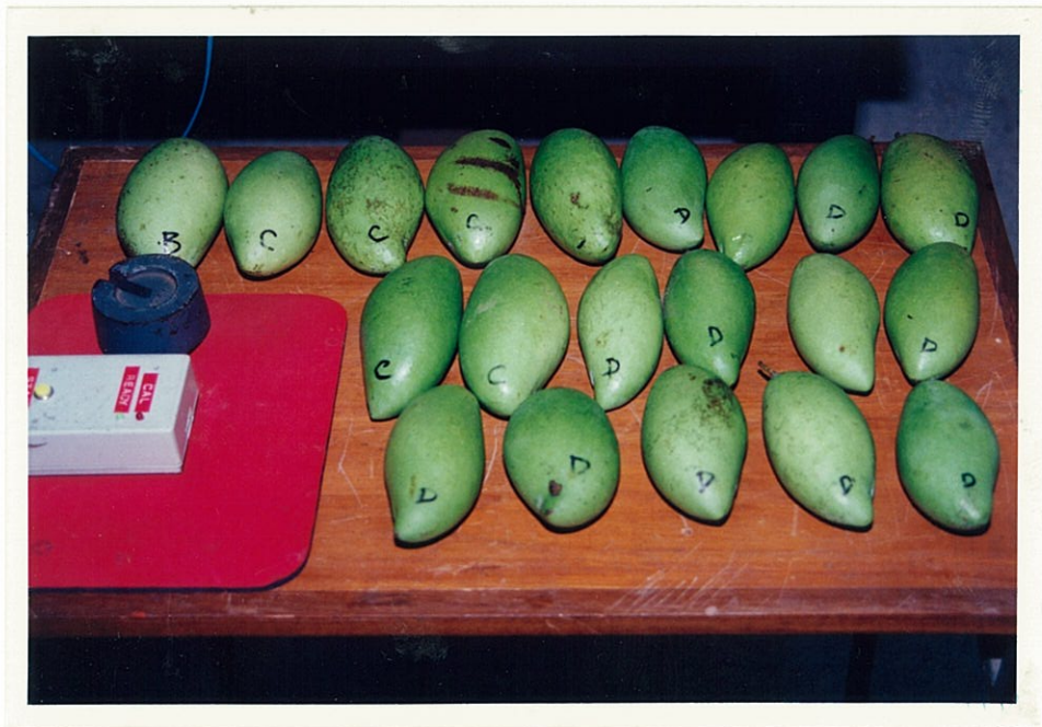
รูปที่ 54 ลักษณะของมะม่วงที่นำมาทดลองคัดขนาด
