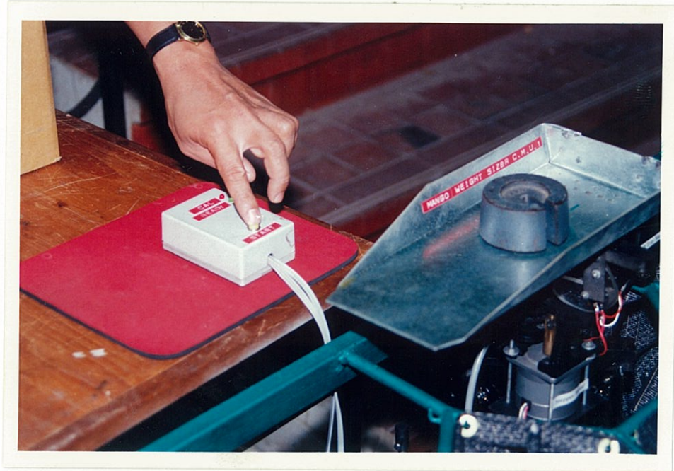
รูปที่ 57 การ Calibrate ด้วยน้ำหนักมาตรฐานก่อนเริ่มทำการคัดขนาดผลมะม่วง
