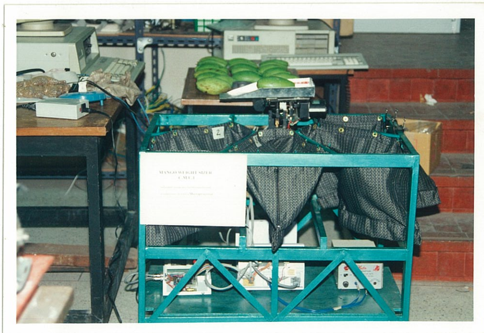
รูปที่ 1 เครื่องคัดผลมะม่วง โดยใช้น้ำหนักเป็นเกณฑ์
