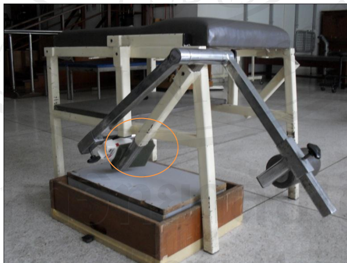
ภาพ 12 แสดง Hand-held dynamometer ที่ติดอยู่กับ N-K table
