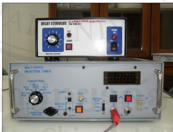
ภาพ 6 แสดงชุดทดสอบ Reaction timer (THAI PHAN, Thailand) (ล่าง) และเครื่อง Delay timer (บน)
