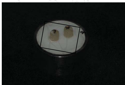
รูป 8 ลักษณะการยึดติดของเรซินซีเมนต์กับเซรามิกส์
