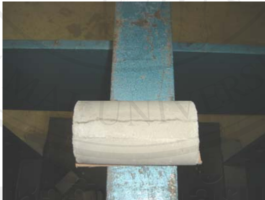
ภาพ 4.13 ลักษณะการแตกหักของแท่งมอด้าเมื่อทำการทดสอบการรับแรงดึงแบบกดด้านข้าง (Split Tensile Test)
