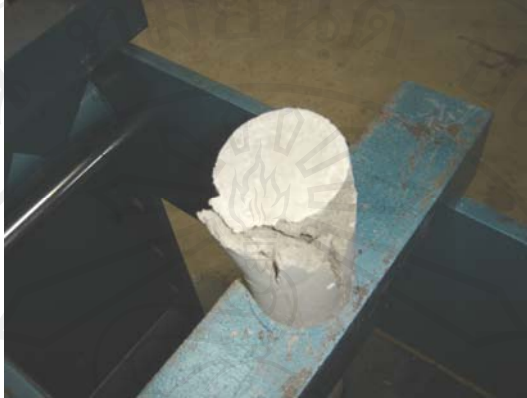
ภาพ 4.12 ลักษณะการแตกหักของแท่งมอด้าเมื่อทำการทดสอบการรับแรงอัด
