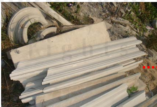
ภาพ 1.1 ตัวอย่างบัวสำเร็จรูปที่ผลิตจากซีเมนต์มอนต้าและการนำไปติดตั้งรอบวงกบหน้าต่าง
