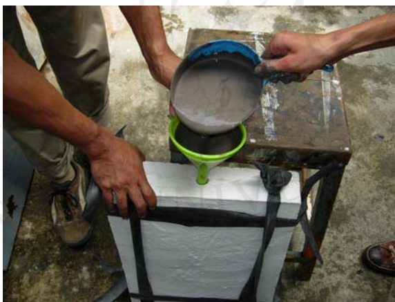
ภาพที่ 4.71 การกรอกน้ำดินเข้าไปในแม่พิมพ์
