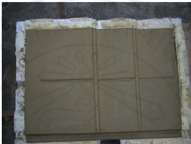
ภาพที่ 4.72 กระเบื้องดินเผาที่นำออกจากแม่พิมพ์
