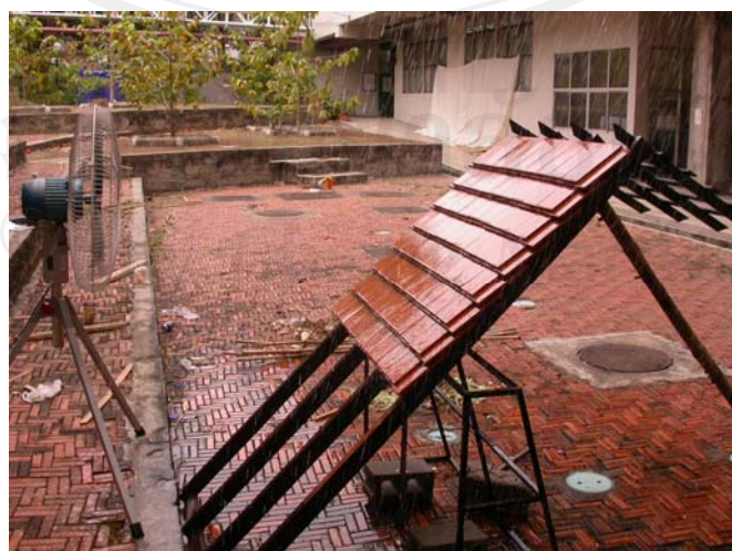
ภาพที่ 4.8 การพ่นน้ำกระทบพื้นหลังคาชนิดเรียบ 2 ด้าน
