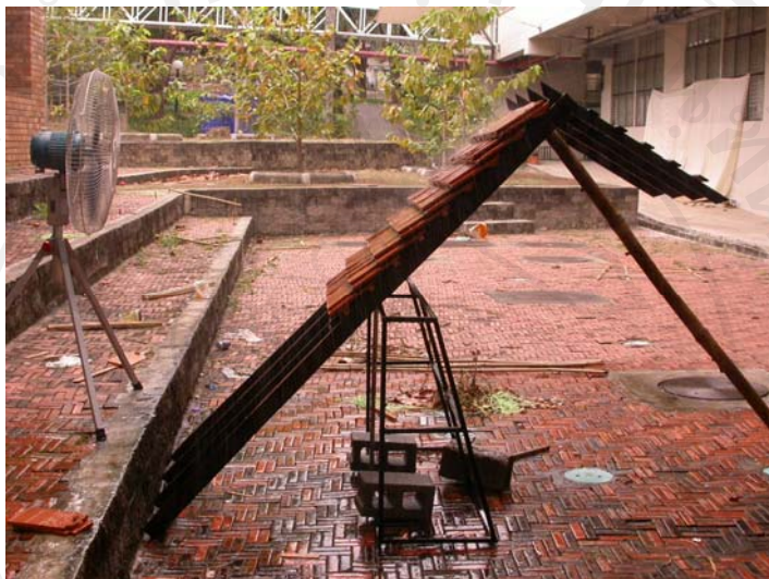
ภาพที่ 4.13 การพ่นน้ำกระทบพื้นหลังคาชนิด จส.
