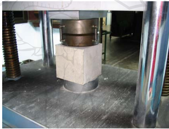
ภาพ 13 การทดสอบความสามารถในการรับแรงอัดด้วยเครื่องทดสอบวัสดุเอนกประสงค์
