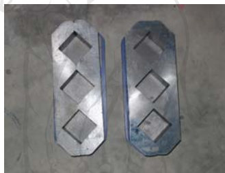
ภาพ 7 แบบหล่อคอนกรีต
