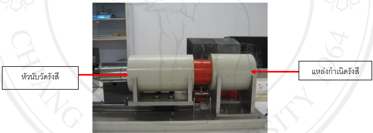
รูปที่ 3.6 การจัดวางอุปกรณ์เพื่อับวัดรังสีในการหาค่าสัมประสิทธิ์การลดทอนเชิงมวลของแก้ว
