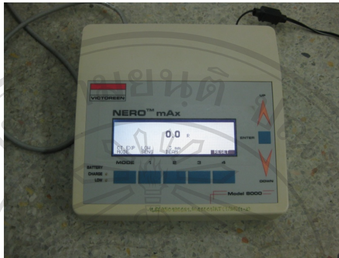
รูปที่ 23 เครื่องแสดงปริมาณรังสี(Exposure)ในหน่วย Roentgen
