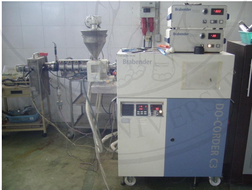
รูป ก-3 เครื่องเอนซ์ทรูเดอร์แบบสกรูเดี่ยว
