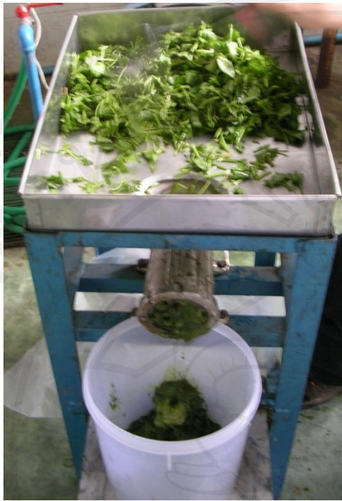
ภาพ ก-2 การบดละเอียดสมุนไพรด้วยเครื่องบดเนื้อ ภาพ ก-3 เครื่องคั้นน้ำใบเตยแบบไฮดรอลิก
