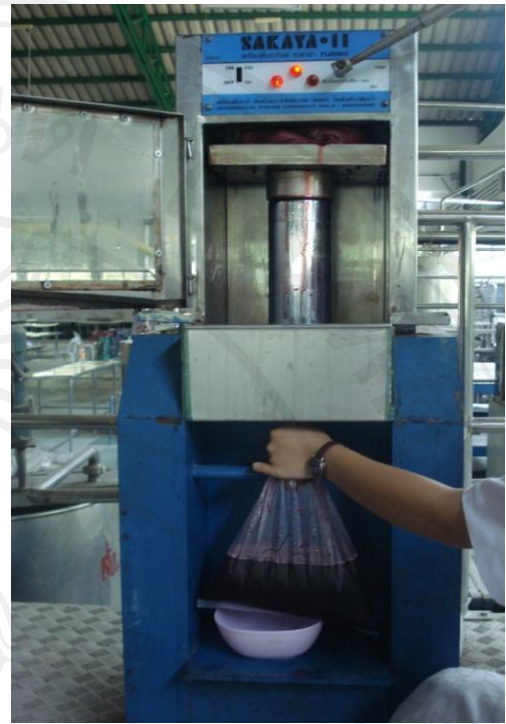
ภาพ ก-2 การบดละเอียดสมุนไพรด้วยเครื่องบดเนื้อ ภาพ ก-3 เครื่องคั้นน้ำใบเตยแบบไฮดรอลิก
