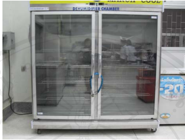
รูปจ-3 เครื่องอบแห้งแบบปั๊มความร้อนภายใต้รังสีอัลตราไวโอเล็ต
