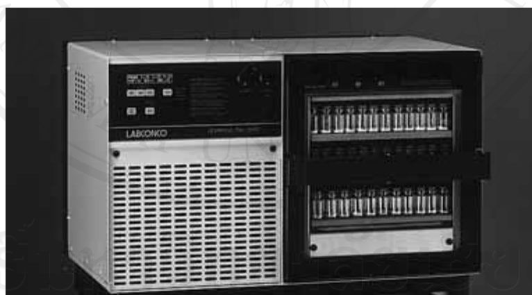
ภาพที่ 2.16 เครื่องทำแห้งแบบแช่เยือกแข็งที่ใช้หลักการ batch method
