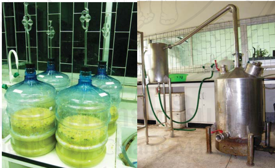
ภาพ ก-2 ถังหมักส้มและถังกลั่นที่ใช้ผลิตสุรากลั่นจากส้มสายน้ำผึ้ง
