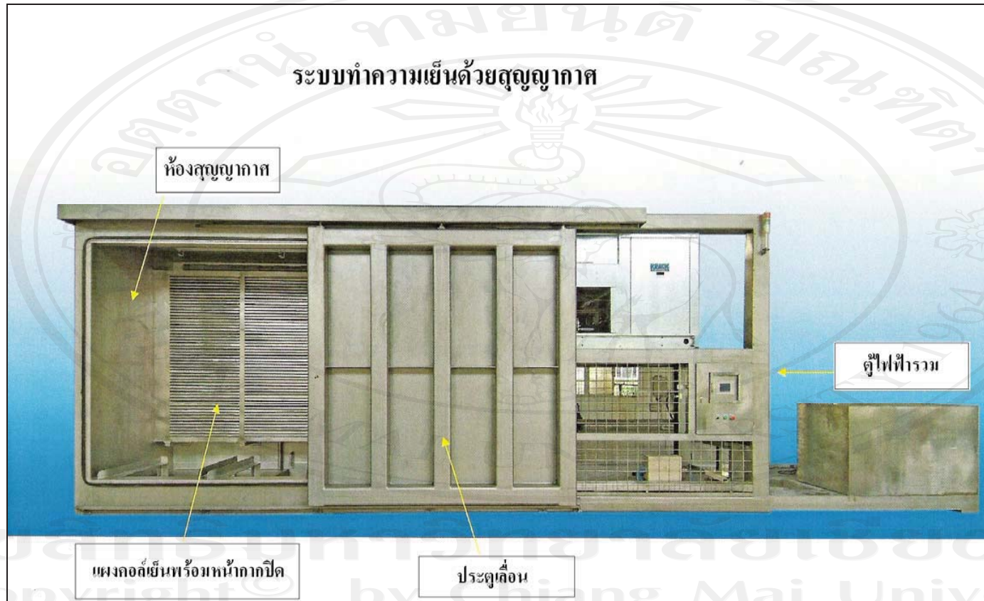
ภาพภาคผนวกที่ 33 ส่วนประกอบของเครื่องลดอุณหภูมิแบบสุญญากาศ
