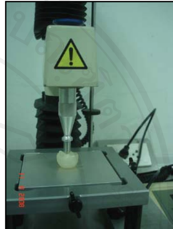
ภาพที่ 3.2 การวัดความแน่นเนื้อของเนื้อลำไยด้วยเครื่องวัดลักษณะเนื้อสัมผัส
