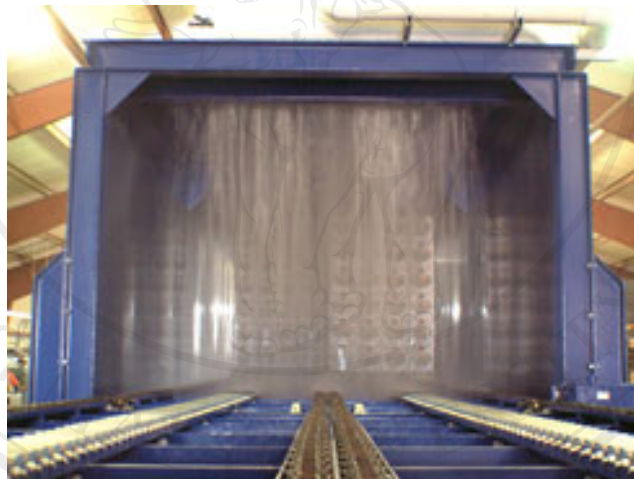
ภาพที่ 3 การลดอุณหภูมิโดยใช้น้ำเย็น
