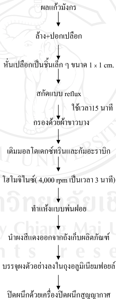
ภาพ 3.1 กรรมวิธีการสกัดสารสีแดงจากเปลือกแก้วมังกรและวิธีการทำแห้งแบบพ่นฝอย
