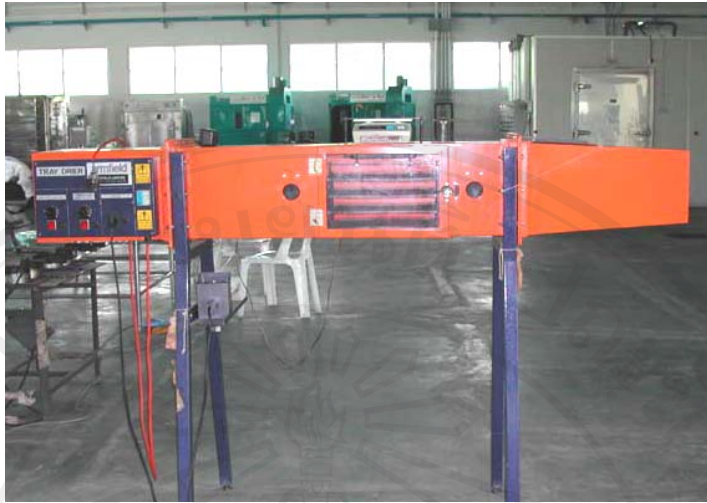
ภาพ 3.2 เครื่องอบแห้งแบบถาด (tray dryer)
