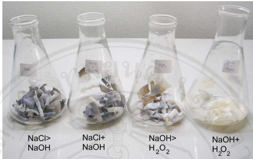
รูปที่ ค-3 หน้งปลาที่ผ่านการปรับสภาพด้วยสารละลายต่างๆ
