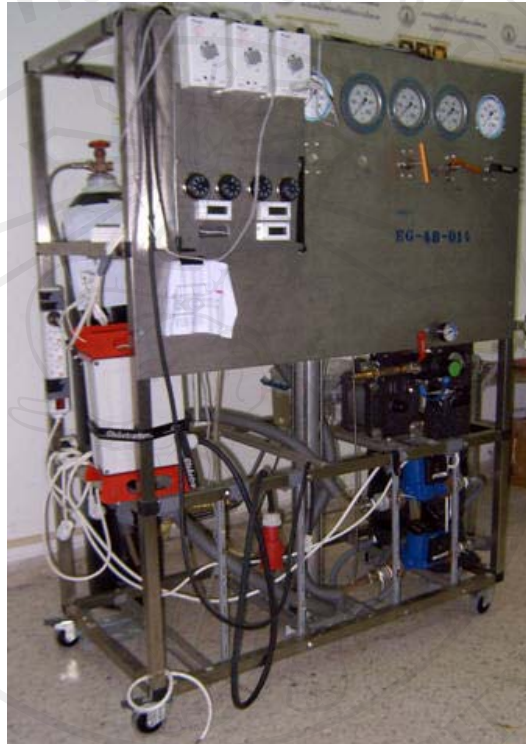
รูปที่ 2.8 การสกัดด้วยคาร์บอนไดออกไซด์เหนือจุดวิกฤต
