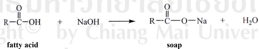
ภาพ 2.16 ปฏิกริยาสะปอนิฟิเคชันของกรดไขมัน ที่มา : Falbe, 1987
