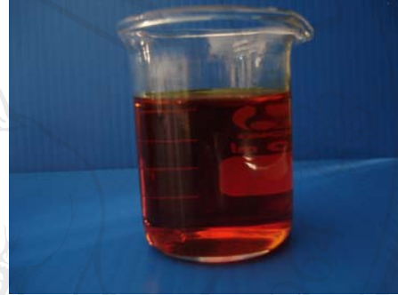
ภาพ ข-4 สารสกัดแคโรทีนอยด์ที่ผ่านการ ระเหยเฮกเซนด้วยระบบสุญญากาศ
