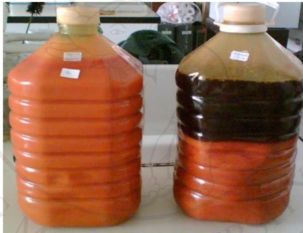
ภาพ ค. 2 น้ำมันปลั้มดิบและน้ำมันปลั้มดิบที่ผ่านการดีกัมแล้ว (จากซ้ายไปขวา)
