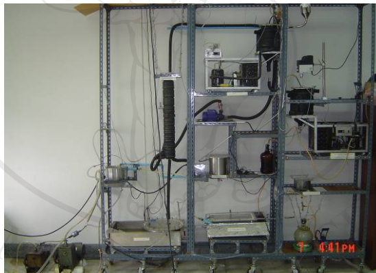
ภาพ ค.5 เครื่องสกัดแครโรทีนอยด์จากน้ำมันปาล์มดิบ
