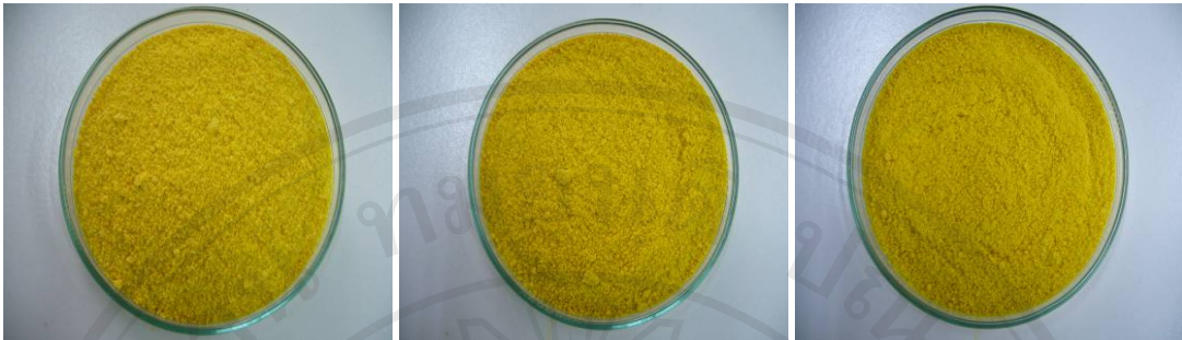
ภาพ ค.13 แคโรทีนอยด์แห้งรูปอิมัลชันที่ผ่านการทำแห้งด้วยเครื่องไมโครเวฟระบบสุญญากาศ ที่กำลัง 720 วัตต์เป็นเวลา 5, 10 และ 15 นาที (จากซ้ายไปขวา)
