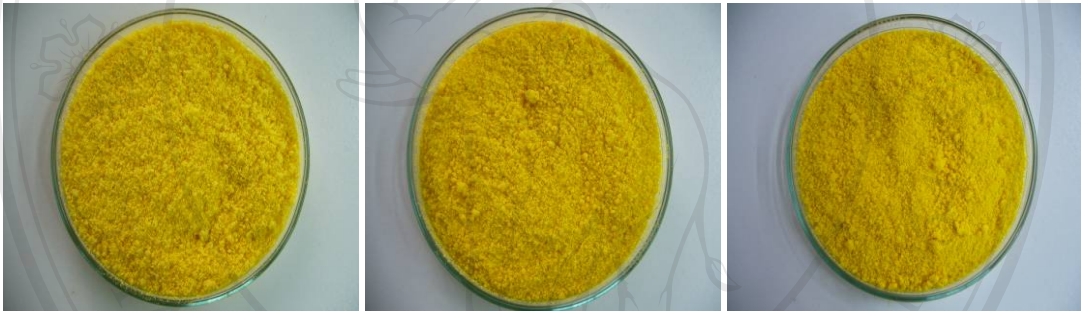
ภาพ ค.26 แคโรทีนอยด์แห้งรูปอิมัลชันที่ผ่านการทำแห้งด้วยเครื่องไมโครเวฟระบบสุญญากาศ ที่กำลัง 960 วัตต์ เป็นเวลา 5, 10 และ 15 นาที (จากซ้ายไปขวา)
