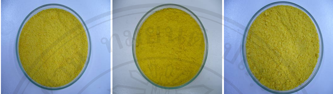
ภาพ ค.16 แคโรทีนอยด์แห้งรูปอิมัลชันที่ผ่านการทำแห้งด้วยเครื่องอบแห้งระบบสุญญากาศ ที่อุณหภูมิ 40 องศาเซลเซียส ที่เวลา 30, 45 และ 60 นาที (จากซ้ายไปขวา)
